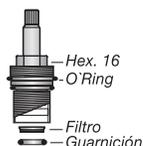
1\_ Retire la cabeza utilizando una llave de boca 16 mm y verifique si el filtro está tapado.
