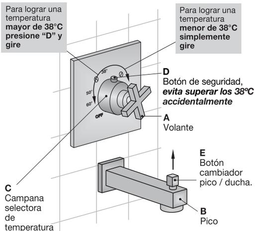
Al girar el volante 'A' obtendrá agua a través del pico 'B'. Si desea obtener salida de agua por la ducha, tire del botón 'E'. Para seleccionar la temperatura deseada utilice la campana 'C'. Para obtener temperaturas superiores a 38°C debe presionar el botón 'D' y girar la campana hacia la izquierda. Para temperaturas inferiores solamente gire la campana hacia la derecha.
