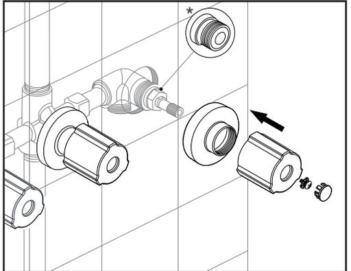
3\_ Para la instalación del pico salida, primero deberá colocar el refuerzo plástico y después la roseta metálica. Por último enrosque el pico salida.
