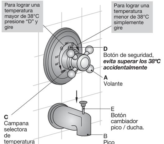
Al girar el volante 'A' obtendrá agua a través del pico (B). Si desea obtener salida de agua por la ducha, baje el botón 'E'. Para seleccionar la temperatura deseada utilice la campana 'C'. Para obtener temperaturas superiores a 38°C debe presionar el botón 'D' y girar la campana hacia la izquierda. Para temperaturas inferiores solamente gire la campana hacia la derecha.
