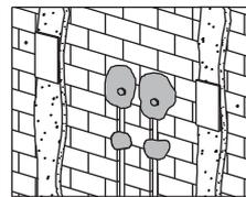
Asegure las cañerías con cemento. Retire la plantilla y cimente los codos.
