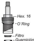
1. Retire la cabeza utilizando una llave de boca 16 mm y verifique si el filtro está tapado.
