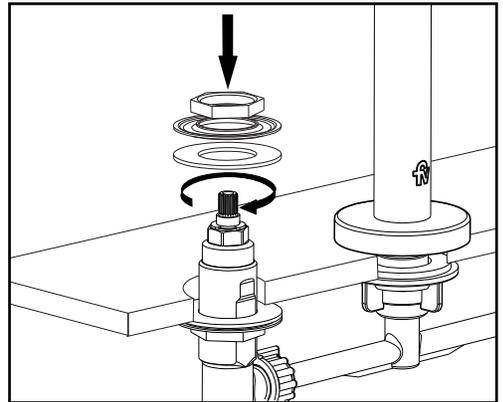
3\_ Por ultimo enrosque la roseta, luego coloque el volante y fije este con el tornillo y la arandela aleteada. Finalmente coloque la letra decorativa para tapar el tornillo.
