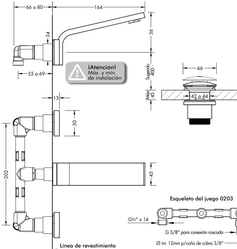
Cuando ubique la grifería en la pared preste especial atención a las medidas máximas y mínimas y a la medida de conexión de entradas y salidas.
