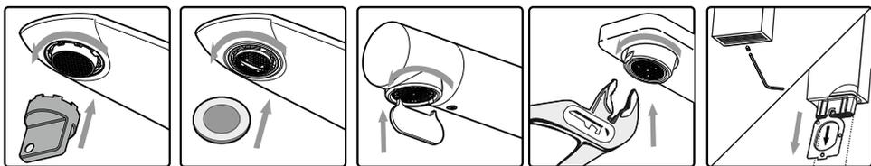
Coloque la herramienta correspondiente según el tipo de aireador que posea y lavelo bajo un chorro de agua. Si está tapado colóquelo en un vaso de vinagre durante la noche. Al día siguiente vuelva a armarlo.
